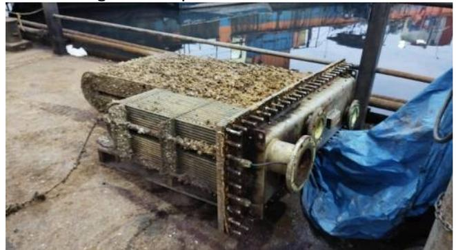
Enviar os resfriadores para uma empresa especializada é fundamental para execução de uma limpeza química, teste hidrostático e tratamento dos tubos com um verniz especial que facilita a troca de calor.
