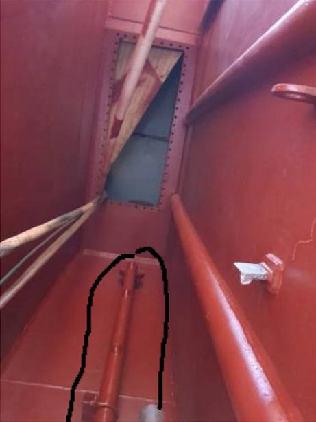
Fabricação com tubo galvanizado de 2", quatro difusores de 1" para 1/2"
