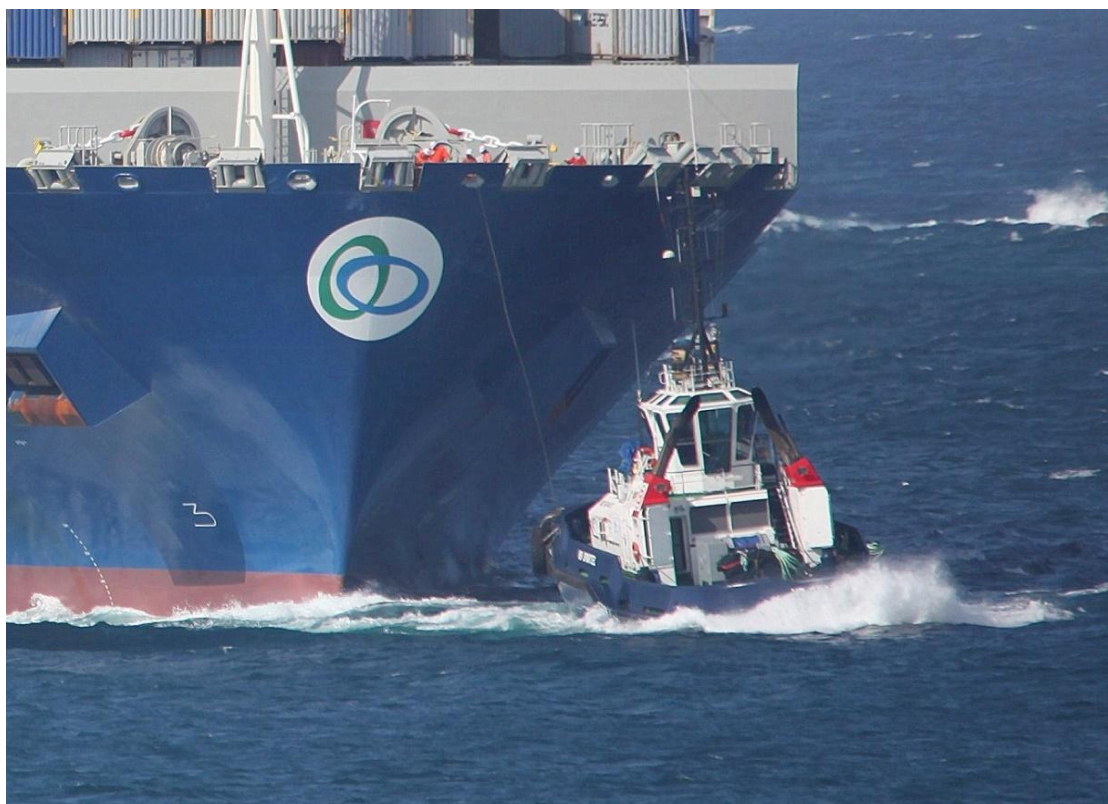
Situação de risco próximo da proa. Rebocador se preparando para passar o cabo de reboque. Do livro 'Tug Use in Port,' 4a edição. 2021.
